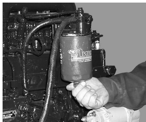
Рис. 14.3. Слив отстоя из фильтра тонкой очистки
