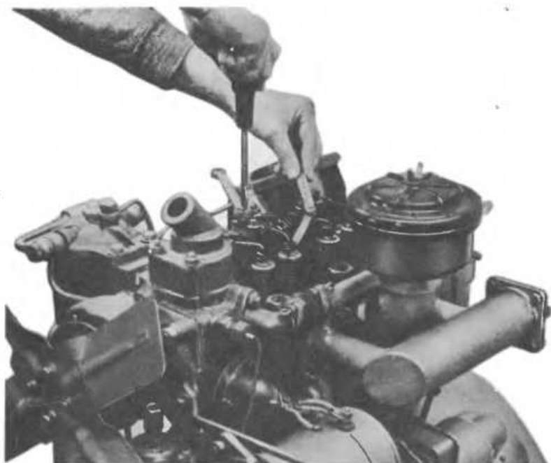
Рис. 139. Проверка зазора в клапанах
