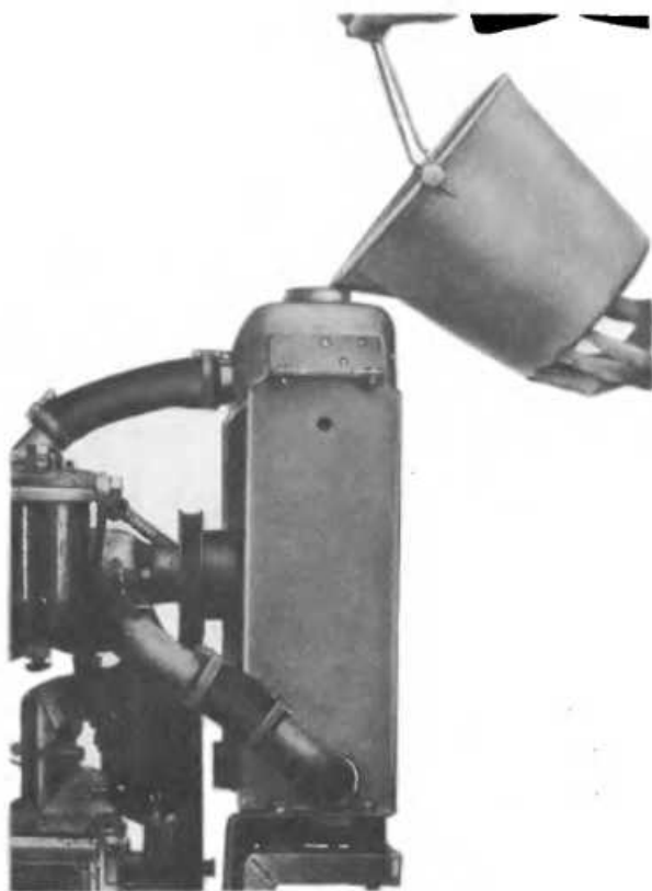
Рис. 101. Заливка охлаждающей жидкости в систему охлаждения
